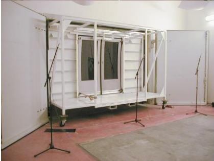
Montage baie entière
