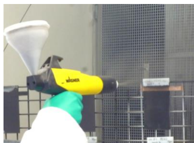
Pistolet Corona et cabine de pulvérisation pour peinture poudre
