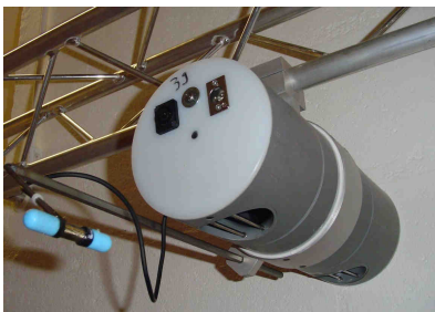
Module (actuateur + microphone) pour dispositif de contrôle actif
