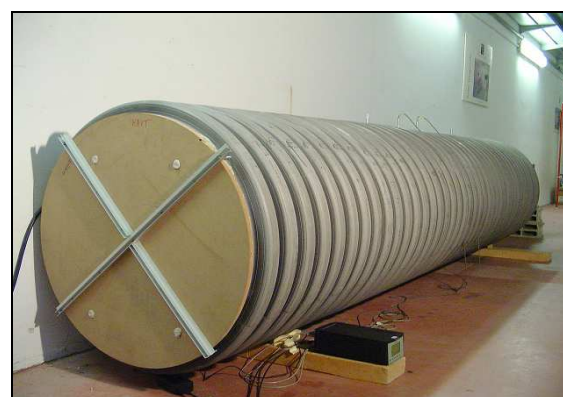
Tube de Kundt de diamètre 700 mm
