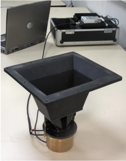
Mesure de l'impédance d'entrée de guide d'onde
